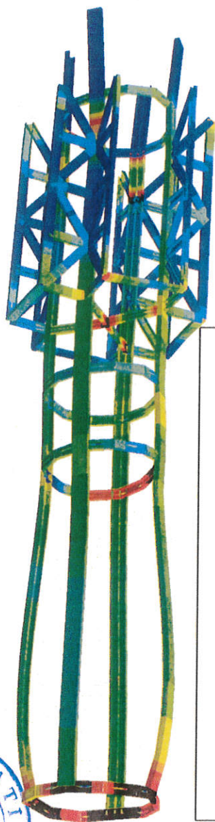
Εικόνα 116. Μεταλλική ενίσχυση δόπευ κωδωνοστατίου, κλίμακα παραμόρφωσης \times 20 , στη χρονική στιγμή t=21 sec, τάση von-Mises [kPa].
